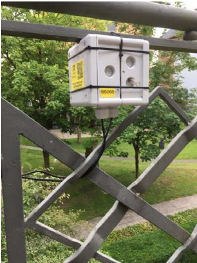
Foto's 4, 5 & 6, Bevestigd, met tie wraps aan een balustrade, of aan een paal, lat of bezemsteel (in de vrije ruimte op afstand van de beplanting)
