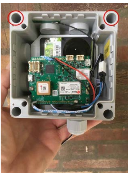
Foto 6, Open unit met rood omcirkelde schroefgaten
