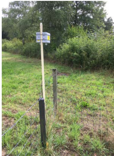
Foto's 4, 5 & 6, Bevestigd, met tie wraps aan een balustrade, of aan een paal, lat of bezemsteel (in de vrije ruimte op afstand van de beplanting)
