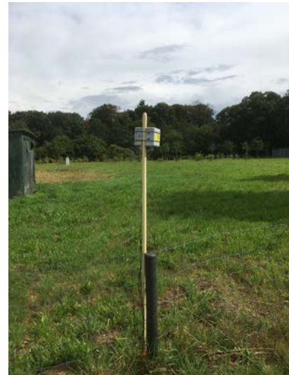
Foto's 4, 5 & 6, Bevestigd, met tie wraps aan een balustrade, of aan een paal, lat of bezemsteel (in de vrije ruimte op afstand van de beplanting)
