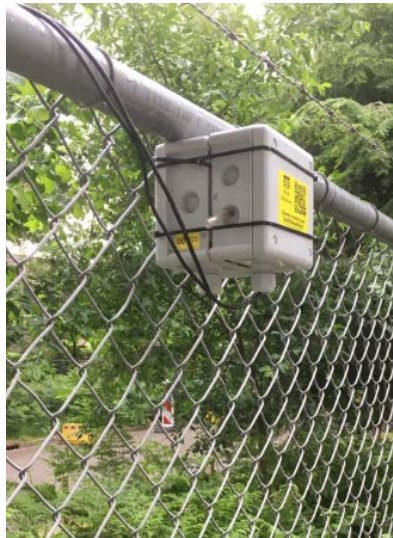
Foto's 1, 2 & 3, Ophangen / bevestigen met tie wraps, of met schroeven op een wand
