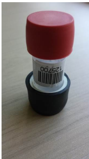
Stap 9: Op het buisje zit een barcode. Plaats het nieuwe meetbuisje zodanig in de houder dat de barcode aan de dichte zijde van de houder zit. Let er ook op dat de witte kant van het meetbuisje aan de onderzijde zit.
